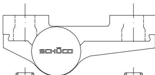
Aufsatztürband Gen. IV mit Reduzierhülse Art.-Nr. 240317 und Formschraube 240365.
