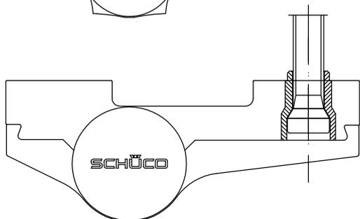
Aufsatztürband Gen. IV mit Reduzierhülse Art.-Nr. 240317 für vorhandene Formschraube.
