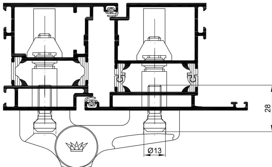
Aufsatztürband Gen. I mit Kegelbuchse für Befestigungsdübel mit Sonderkopfschraube.
