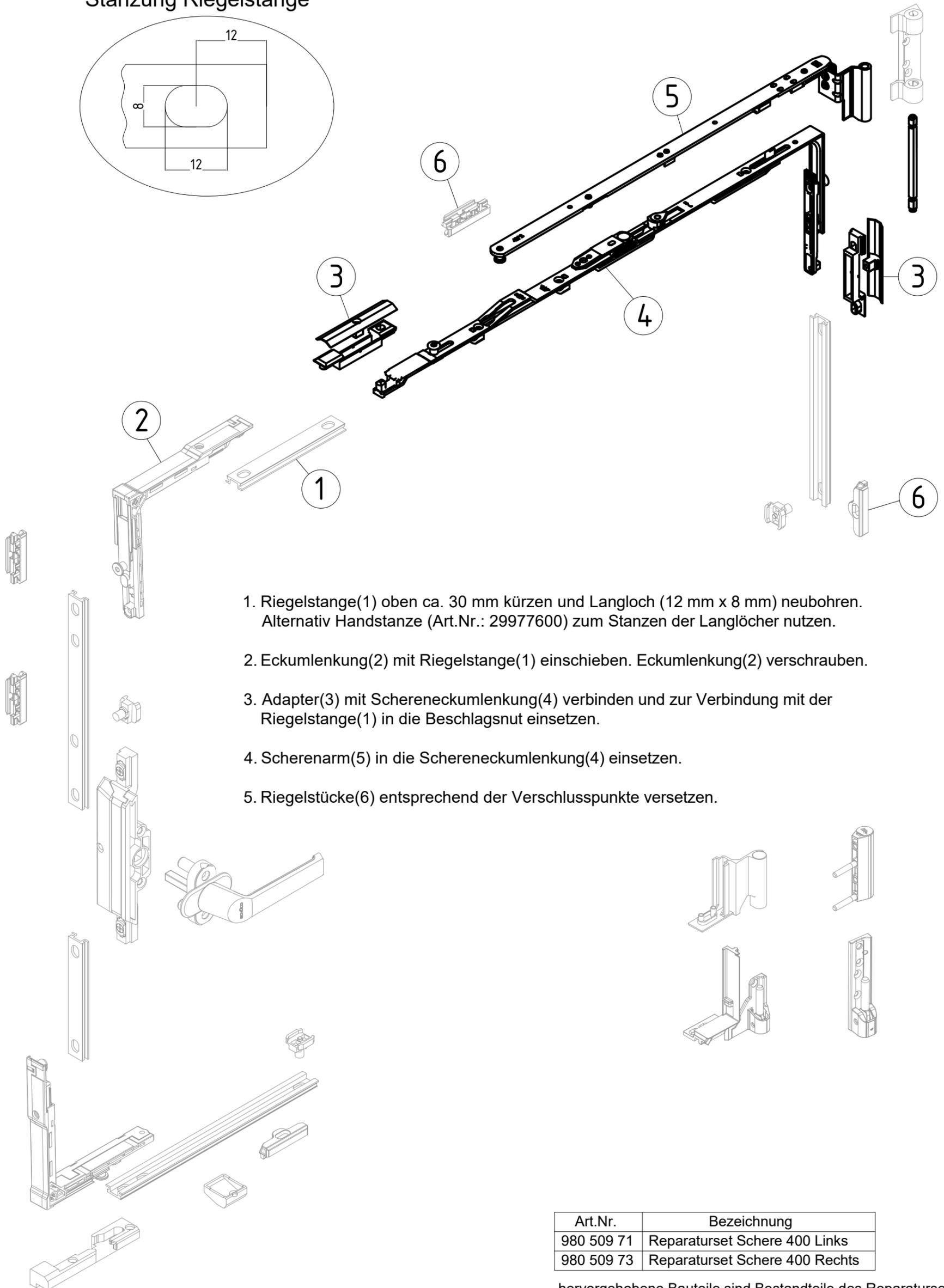
1. Riegelstange(1) oben ca. 30 mm kürzen und Langloch (12 mm x 8 mm) neubohren. Alternativ Handstanze (Art.Nr.: 29977600) zum Stanzen der Langlöcher nutzen.
