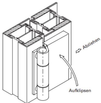
Abdeckkappen montieren. Nicht seitlich aufschieben, sondern über die obere Kante des Flügelteils aufklipsen.
