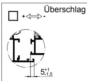
Bei Bedarf ist der Flügelüberschlag horizontal und vertikal zu kontrollieren und auf Maß einzustellen.
