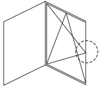
Vor der Demontage des Fingerriegels ist das Kammergetriebe und der Griff zu entfernen.
