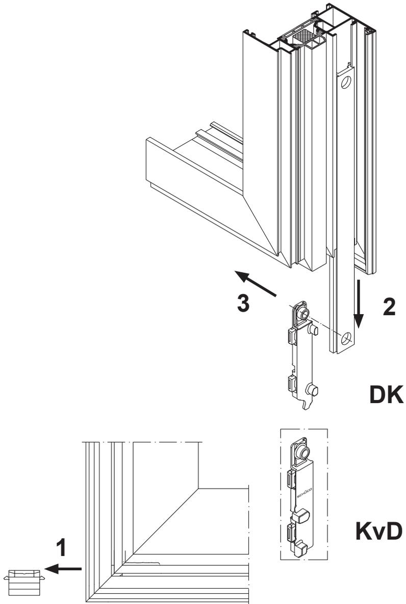
1. Entlastungslager aus Riegelstangenut entfernen.
