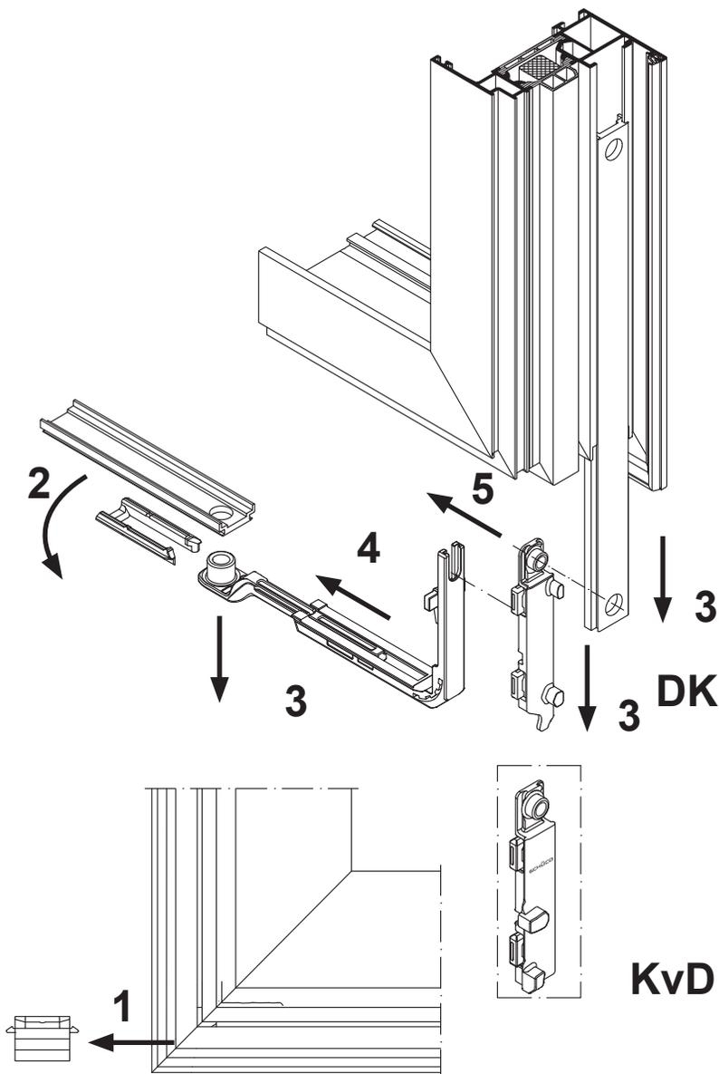
1. Entlastungslager aus Riegelstangenut entfernen.
