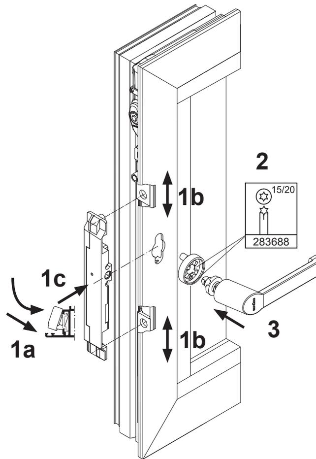
1. Kammergetriebe einschwenken und mit Riegelstange koppeln.
