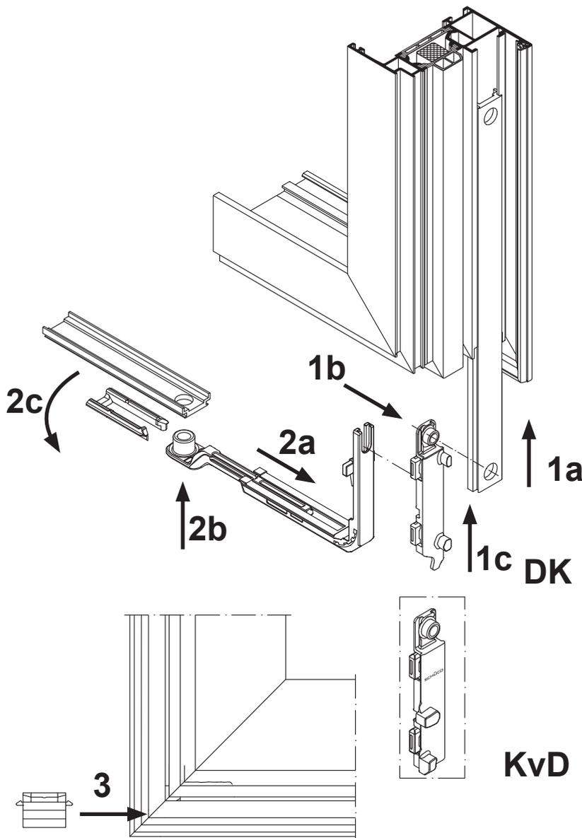
1. Fingerriegel in griffseitige untere Riegelstange einkoppeln und in Riegelstangennut einschieben.
