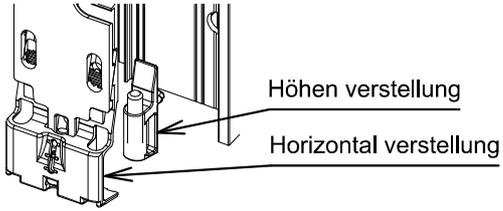
4. Blendrahmenteil und Flügelteil montieren und festschrauben
