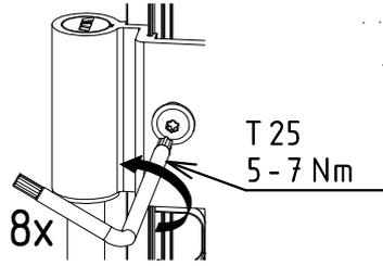
5. Flügel einsetzen in Blendrahmen, Bolzen einschieben und Abdeckkappe montieren
