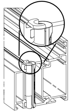
2. Befestigung einschieben und positionieren
