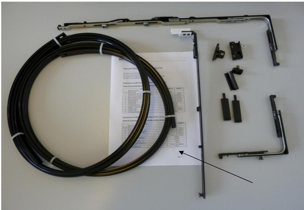
Vor Beginn der Montage tauschen Sie bitte den im Reparaturset enthaltenen Scherenarm durch den zusätzlichen Scherenarm aus.
