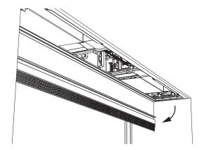
Um die (optionalen) Coarse 45% (G3)- oder ePM1 75% (F7)-Filter des Schüco VentoTherm Twist anzubringen oder auszutauschen, muss die Wartungsklappe / Sichtblende des Lüftungsgerätes geöffnet werden.
